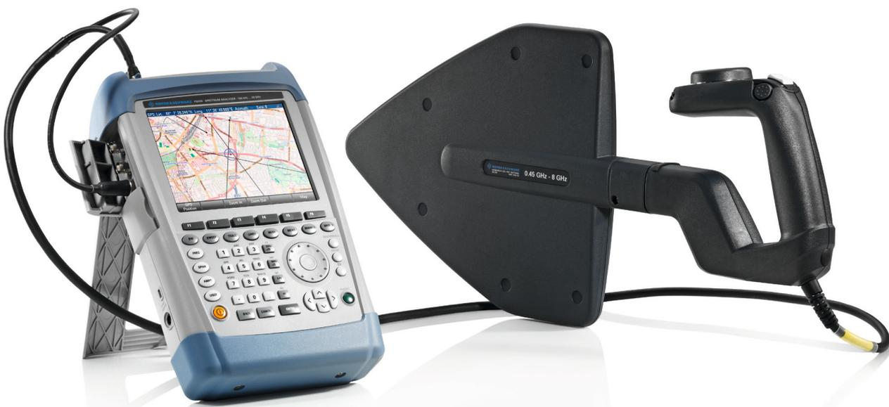
Das Mapping Feature benutzt die Triangulationstechnik um Störer zu lokalisieren. Mit dem R&S®OSM Wizard können Open Street Maps (OSM) einfach auf den R&S®FSH geladen werden.
